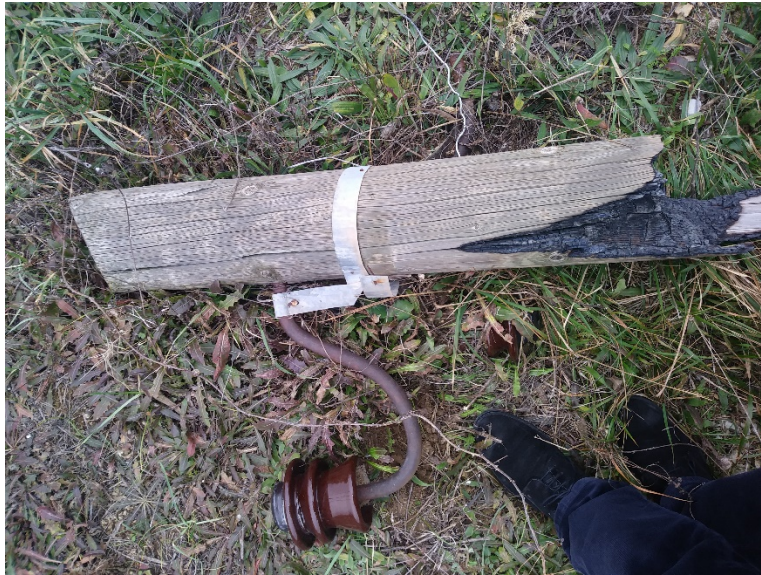
Slika 3. Otpali vrh zapaljenog stupa s prstenima za sprječavanje zapaljenja
